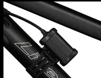
**Akkutypen:** Lupine HardCase Akkus verfügen auf der Rückseite über eine Lasche und werden mit einem Klettband befestigt.
