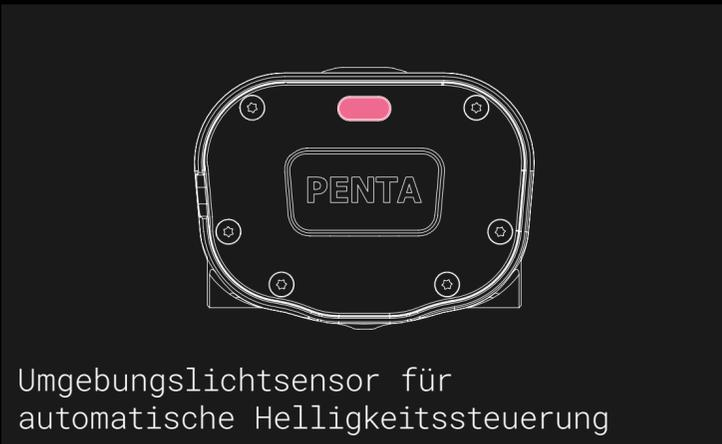
Umgebungslichtsensor für automatische Helligkeitssteuerung
