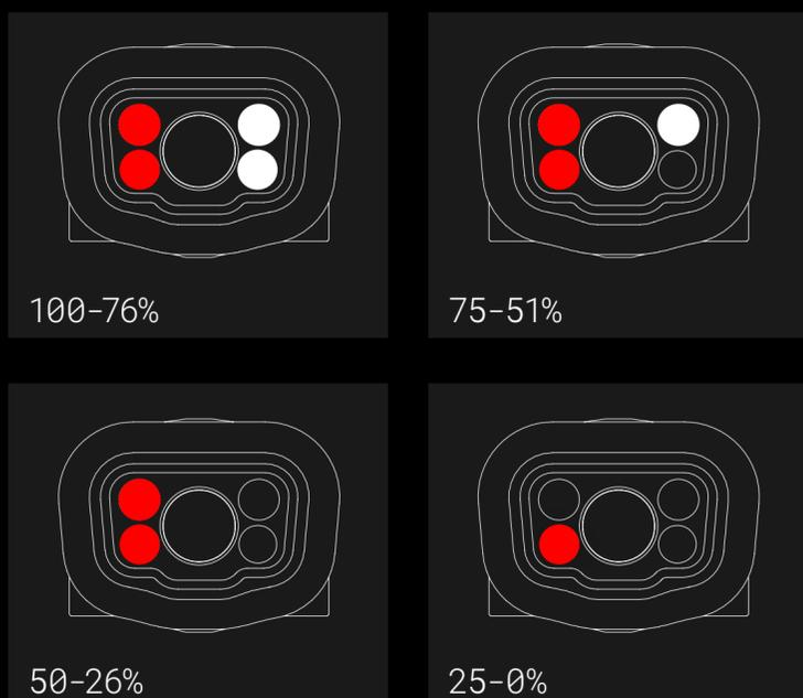
**SmartCore-Akku:** Bei der SmartCore-Version der Penta Pro, lässt sich die Kapazität direkt am Akku-Gehäuse ablesen.
